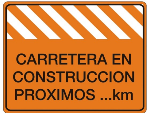
Longitud de la Construcción T 10
