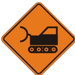
Equipo Pesado en la Vía T 7
